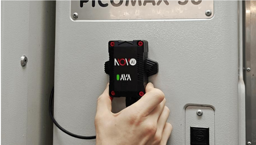
Retrofit in der Praxis: externer AVA-Sensor an einer Bestandsmaschine.
