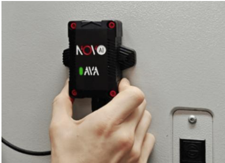
Novo-AI-Retrofit-Sensor an bestehender Abkantpressenausrüstung.
