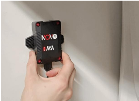
Novo-AI-Nachrüstsensor an bestehender Kabelextrusionsanlage.
